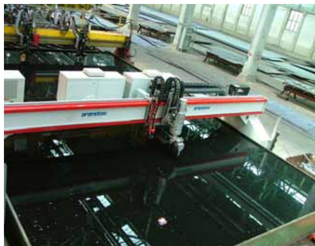
Foto abajo: detalles de la maquina al plasma instalada en los astilleros de la Fincantieri de La Spezia.
